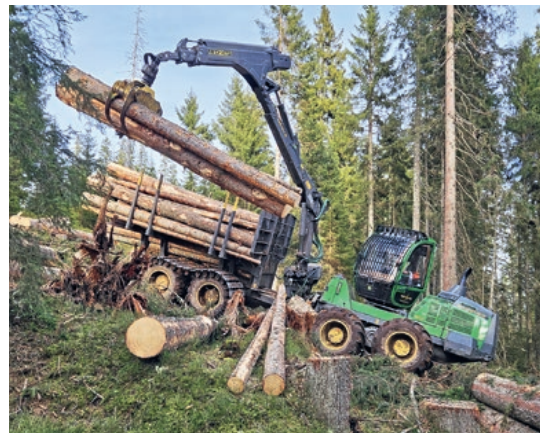
Vollernter im Einsatz im Schlierentalwald und Forwarder beim Holztransport an die Strasse
