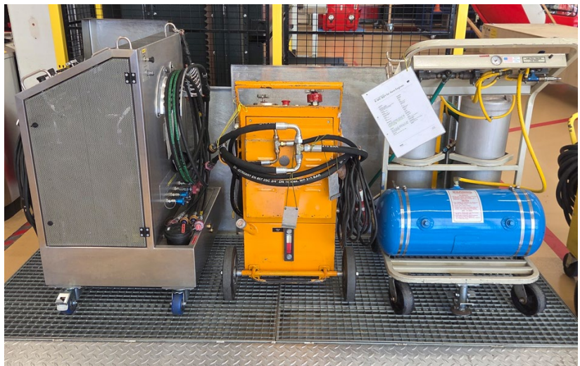
Bild 15: Hydraulik-Aggregate, Kompressor ENG-Wash Module
