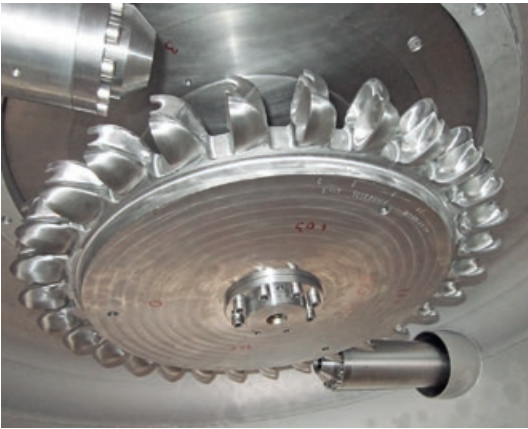
Turbine Gerenstock mit zwei Düsen
