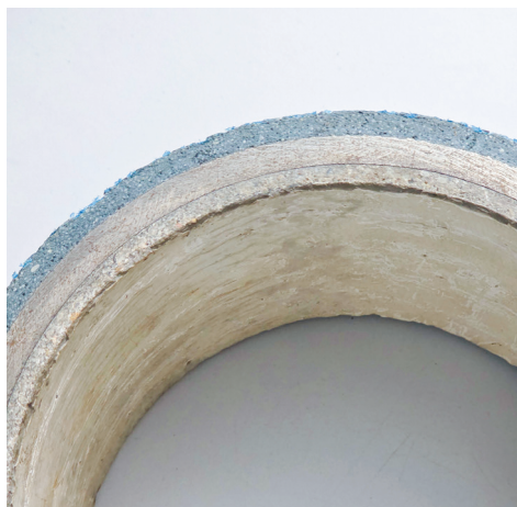
Querschnitt durch ein Wasserrohr aus Gusseisen mit Zementmörtelbeschichtung sowie einer Zinkschicht als Schutz gegen Rost.
