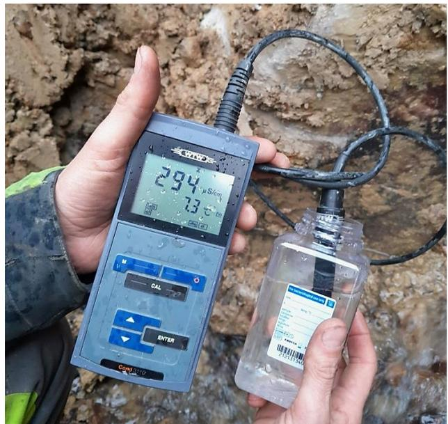
Messung des Quellwassers auf Leitfähigkeit und Temperatur
