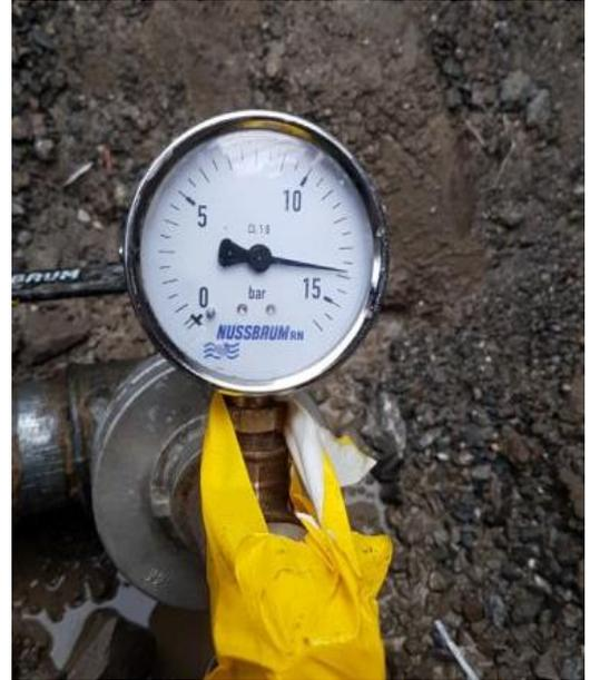
Druckprüfung nach dem Bau von Wasserleitungen
