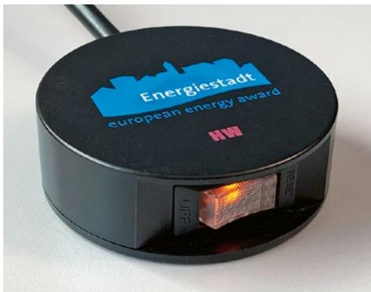
Verbindungsschalter zur Steckdosenleiste zum bequemen Ein- und Ausschalten des Stand-by-Modus aller angeschlossenen Geräte. Dieser Schalter ist bei der Gemeinde Sarnen an jedem Arbeitsplatz im Einsatz.
