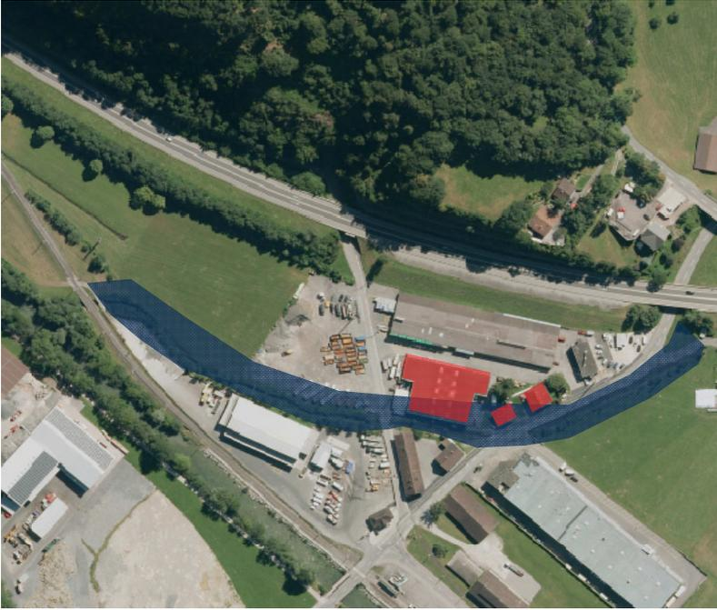
Abb. 3: Ausschnitt Situation Massnahmen Unterlauf. Verbreiterung Bach blau, abzubrechende Häuser rot.
