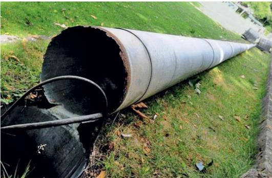
Die obenstehenden Fotos zeigen ein Beispiel einer bau- und jahrgangsgleichen Anlage, welche aufgrund eines Föhnsturms und verpasster Sanierung umgeknickt ist.
